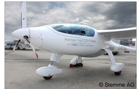
LAPAZ Versuchsträger (modifizierte Stemme S15)
