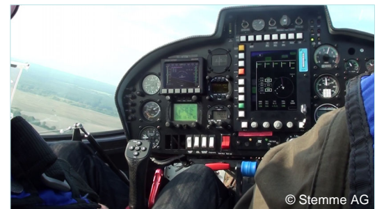
Cockpit der Stemme S15 mit Autopilotenbedieneinheit (AFCP)
