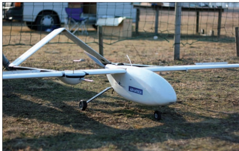
Bild 1. Der Versuchsträger ALEXIS ist ein druckpropellergetriebenes Flugzeug mit zwei Leitwerksträgern, umgedrehtem V-Leitwerk und einer Spannweite von 4 m. Er kann eine Nutzmasse von 1 kg (z.B. Kamera) tragen.
