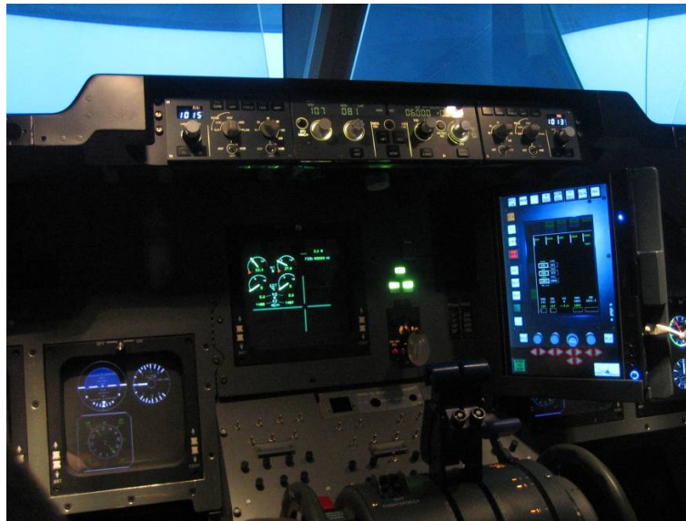
Erprobung der Regelgesetze im Flugsimulator SEPHIR des Fachgebietes Flugmechanik, Flugregelung und Aeroelastizität, © TUB
